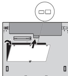
7 Se já houver uma memória SO-DIMM instalada, remova-a conforme a ilustração. Guarde a memória SO-DIMM para utilização futura.
