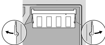
**8** Allineare l'incavo del bordo di contatto del modulo SO-DIMM con il divisore dell'alloggiamento. Inserire il modulo SO-DIMM nell'alloggiamento con angolazione di 20 gradi **1** e girarlo verso il basso fino ad inserirlo correttamente **2**.
