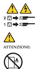
Non poggiare oggetti che pesano più di 82 kg sulla parte superiore delle unità montate in rack.
