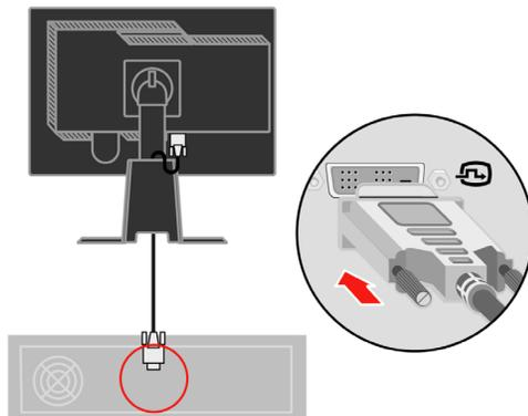
Conecte el cable de señal analógico al conector D-SUB del monitor y el otro extremo al panel posterior de su equipo.
