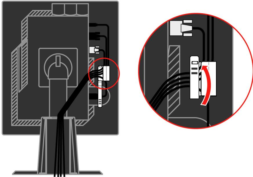
Enrole o fixador de cabos ao redor dos cabos.
