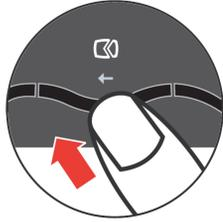
注： 自動Image Setup（画像セットアップ）で希望する画像を設定できない場合は、手動Image Setup（画像セットアップ）をお使いください。3-4ページの「手動Image Setup（画像セットアップ）」を参照してください。
