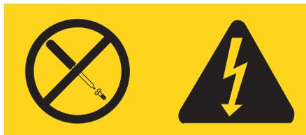
In Komponenten, die so gekennzeichnet sind, können gefährliche Spannungen anliegen. In diesen Komponenten sind keine Teile vorhanden, die vom Benutzer gewartet werden müssen. Besteht der Verdacht, dass an einem dieser Teile ein Fehler aufgetreten ist, ist ein IBM Kundendiensttechniker zu verständigen.
