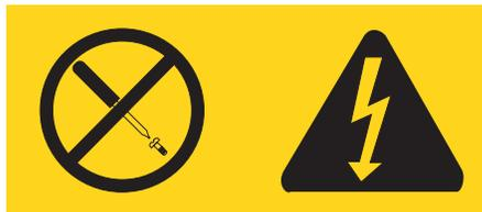
Des tensions et des courants dangereux sont présents à l'intérieur de tout composant sur lequel est apposée cette étiquette. Ces éléments ne peuvent pas être réparés. Si vous pensez qu'ils peuvent être à l'origine d'un incident, prenez contact avec un technicien de maintenance.
