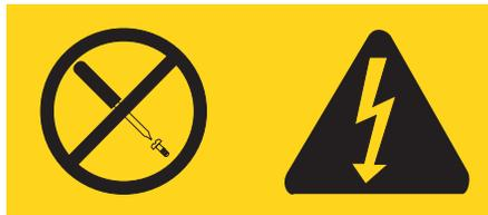
Níveis perigosos de voltagem, corrente e energia estão presentes em qualquer componente que tenha esta etiqueta afixada. Nenhuma peça localizada no interior desses componentes pode ser consertada. Se você suspeitar de algum problema em alguma dessas peças, entre em contato com um técnico IBM.
