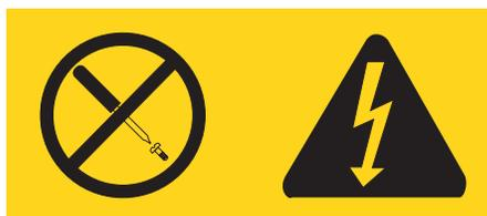
Tensioni pericolose, corrente e livelli di energia sono presenti all'interno del componente su cui è posta questa etichetta. All'interno di questi componenti non vi sono parti su cui effettuare l'assistenza tecnica. Se si sospetta un problema in una di queste parti, rivolgersi ad un tecnico di manutenzione.
