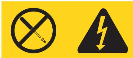
Existen niveles perjudiciales de energía, corriente y voltaje en los componentes que tienen adherida esta etiqueta. Dentro de estos componentes no existe ninguna pieza que requiera mantenimiento. Si sospecha que alguna de estas piezas tiene un problema, póngase en contacto con un técnico de servicio.
