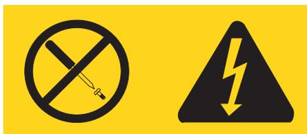
Há níveis de energia, corrente e voltagem perigosos em todos os componentes que possuem essa etiqueta. Não existem peças reaproveitáveis no interior desses componentes. Se você suspeitar de algum problema com uma dessas peças, entre em contato com um técnico de serviço.
