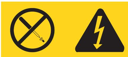
Existen niveles de voltaje, corriente y energía peligrosos en el interior de todos los componentes que lleven adherida esta etiqueta. Dentro de estos componentes no existe ninguna pieza que requiera mantenimiento. Si sospecha que puede haber un problema en una de estas piezas, póngase en contacto con un técnico de servicio.
