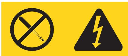
Quaisquer componentes que tenham esta etiqueta anexada, possuem interiormente voltagem, corrente e níveis de energia perigosos. Não existem peças no interior desses componentes que possam ser consertadas. Se você suspeitar de algum problema com uma dessas peças, entre em contato com um técnico de serviço.
