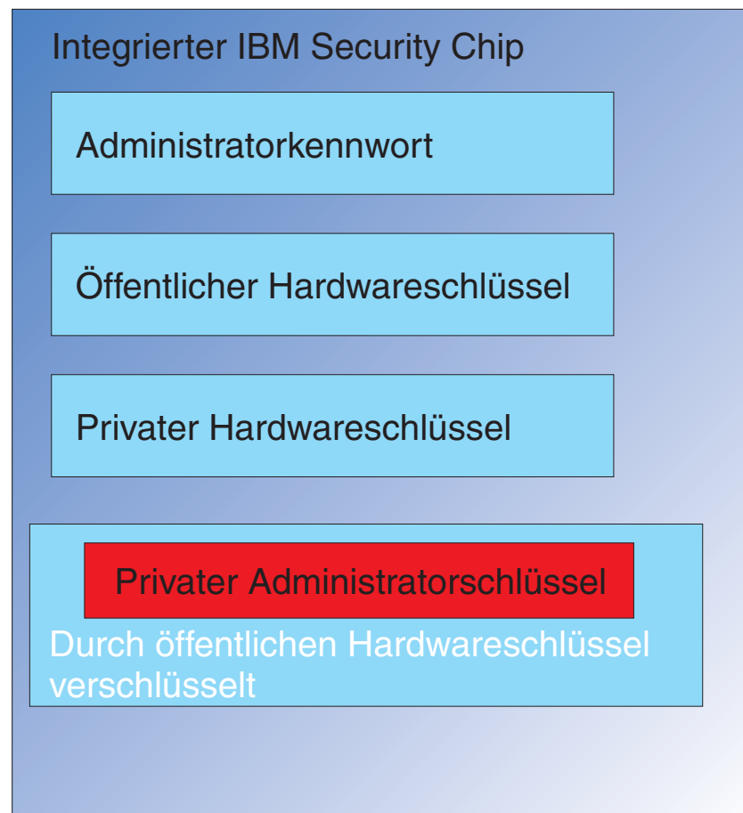
Abbildung 4. Der private Administratorschlüssel, der mit dem öffentlichen Hardware Schlüssel verschlüsselt ist, wird in den integrierten IBM Security Chip geladen.
