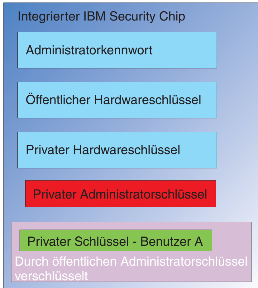
Abbildung 6. Der private Schlüssel von Benutzer A, der mit dem öffentlichen Administratorschlüssel verschlüsselt ist, wird an den Security Chip übergeben.
