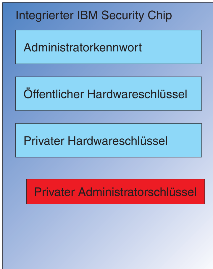
Abbildung 5. Der private Administratorschlüssel kann im Security Chip verwendet werden
