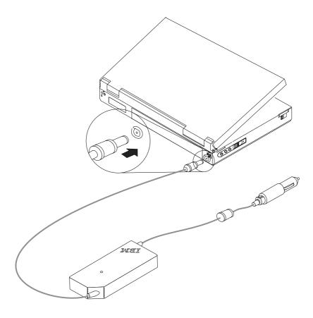
**Etape 2**Tirez sur le connecteur source d'alimentation, comme dans l'illustration ci-après, pour le séparer de la prise pour allume-cigare. Les 4 broches apparaissent alors.
