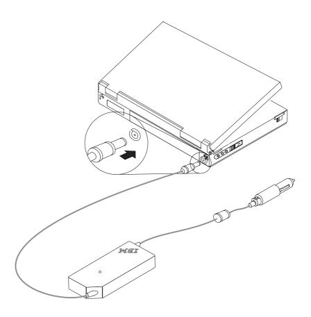
步驟二 將較大的電源接頭插入點煙器插座。當整流器電纜插入通電的電源時,整流器盒上 的綠色發光二極體(LED)會亮起。您可能要啟動汽車引擎才能提供您的電腦電 源。
