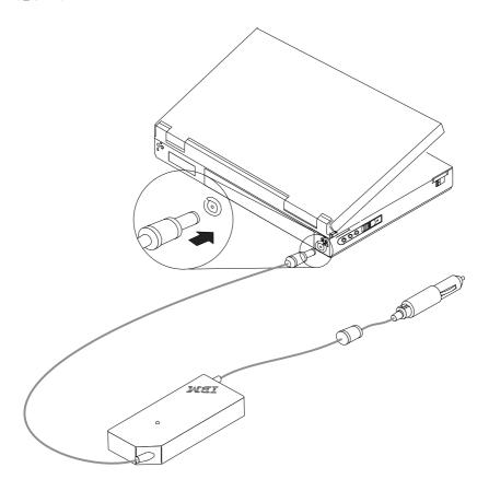
**ステップ 2** 次の図に示すように、電気ソース・コネクターを引っ張って分離し、シガレッ ト・ライター・アダプターを取り外します。4 ピン・コネクターが現れます。
